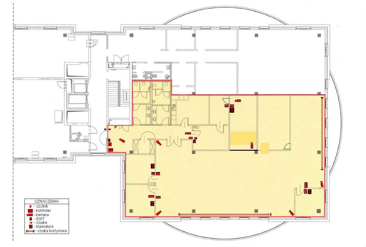
Rys. 3 Lokalizacja elementów systemów zabezpieczenia technicznego – kondygnacja 5
